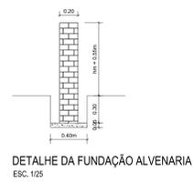
DETALHE DA FUNDAÇÃO ALVENARIA
